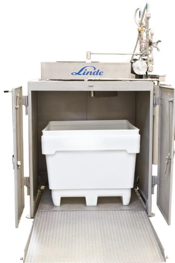
Rychlé ochlazení pomocí Linde Combo Chilleru inhibuje růst bakterií, které mohou ohrozit kvalitu a bezpečnost potravin. Combo chiller podporuje různé přepravní boxy včetně nerezových, plastových (na obrázku) nebo papírových z kartonu.
