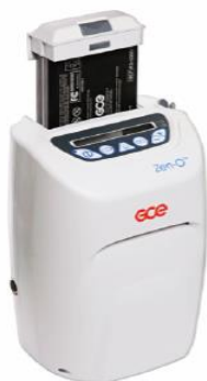
Zen-O™ může obsahovat až dvě 12-ti článkové baterie
